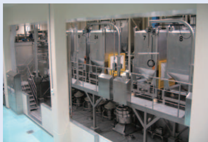
コンテナシステムを採用したミックス粉製造設備
