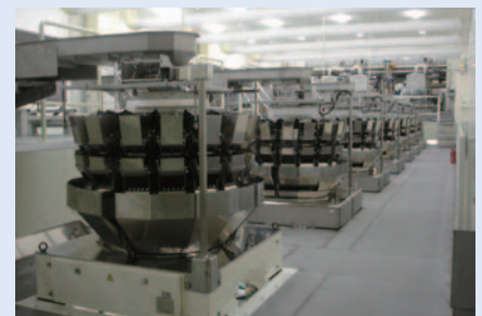
菓子工場の計量設備
